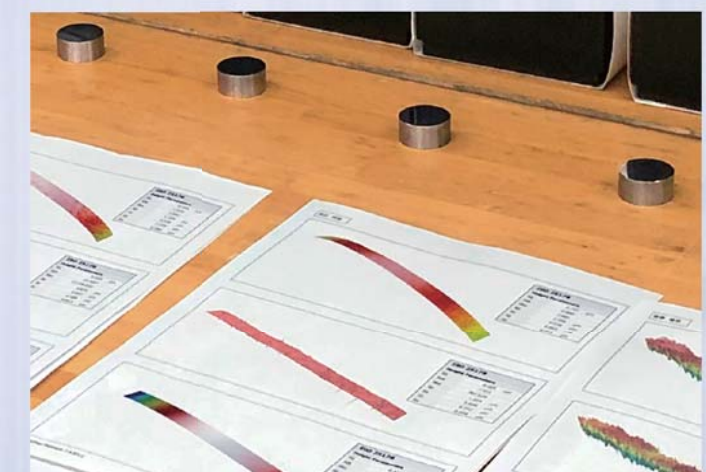
第1回実践加工技量チャレンジカップ選手権 加工製品の最高表面性状・真直度・平面度を計測
